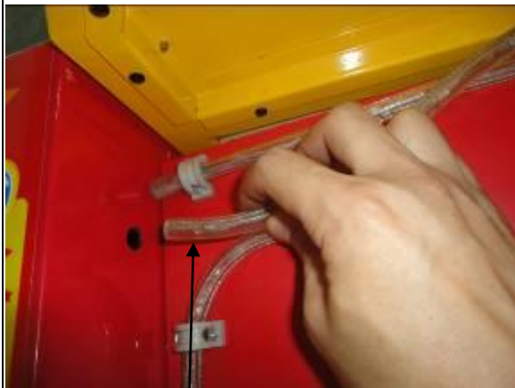
8. ロープライトはシャーシーに入れます
