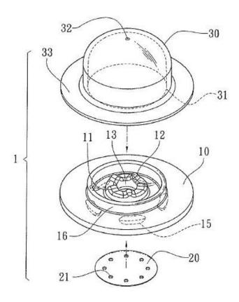
【發明名稱】The construction of simple inflation valve. 簡易式充氣閥構造
