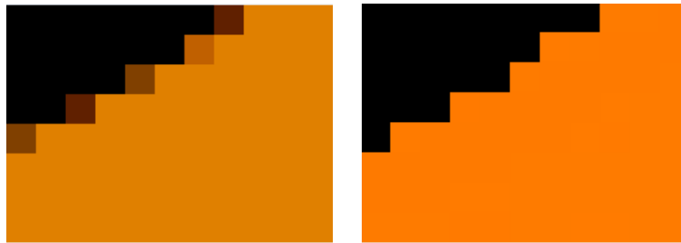
圖 7. 區塊 4 的顏色調整結果，(a)原始區塊，(b)去平滑化的結果。
