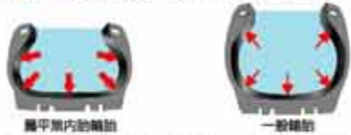
扁平無內胎輪胎空氣容量比一般輪胎容量少20-30%，所以空氣壓要比一般輪胎設定較高。
